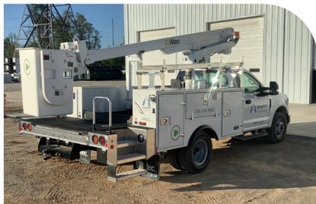
Le camion nacelle de Breezeline utilise un système de gestion de l'énergie sur les chantiers afin de ne pas laisser tourner le moteur lors de l'utilisation de la nacelle.
